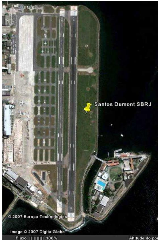
Figura 03 - Aeroporto de Santos Dumont – SBRJ, exemplo de pistas paralelas
