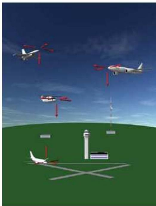
**Figura 21. Esquema de como funciona o ADS-B.**
