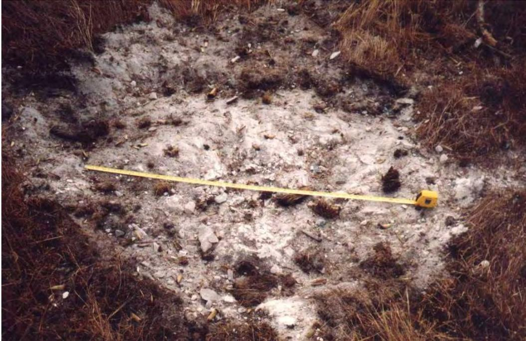
**Figura 22 – Cratera produzida pela segunda bomba BAFG-460 na pedreira de arenito.**
