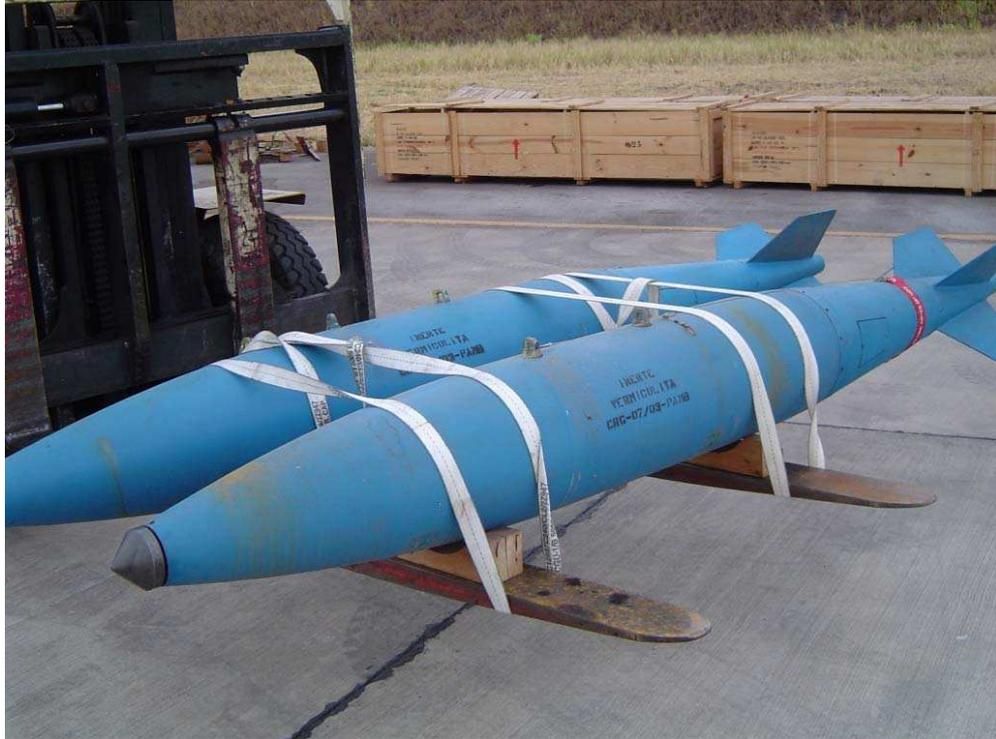
**Figura 19 – BA-FG-460 equipada com ponteira de aço 4340.**
