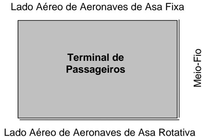
Figura 2: Terminal com Três Lados Operacionais
