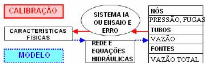
Figura 18: Modelação e calibração de redes de distribuição de água potável [7].
