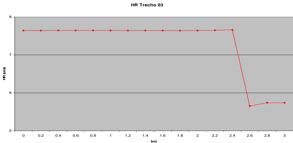
Figura 4.5: Espessura de CBUQ – Trecho 03
