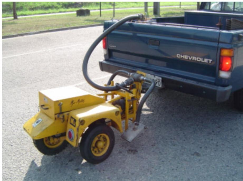
Figura 5.1 – Mu-meter pronto para a medição do atrito
