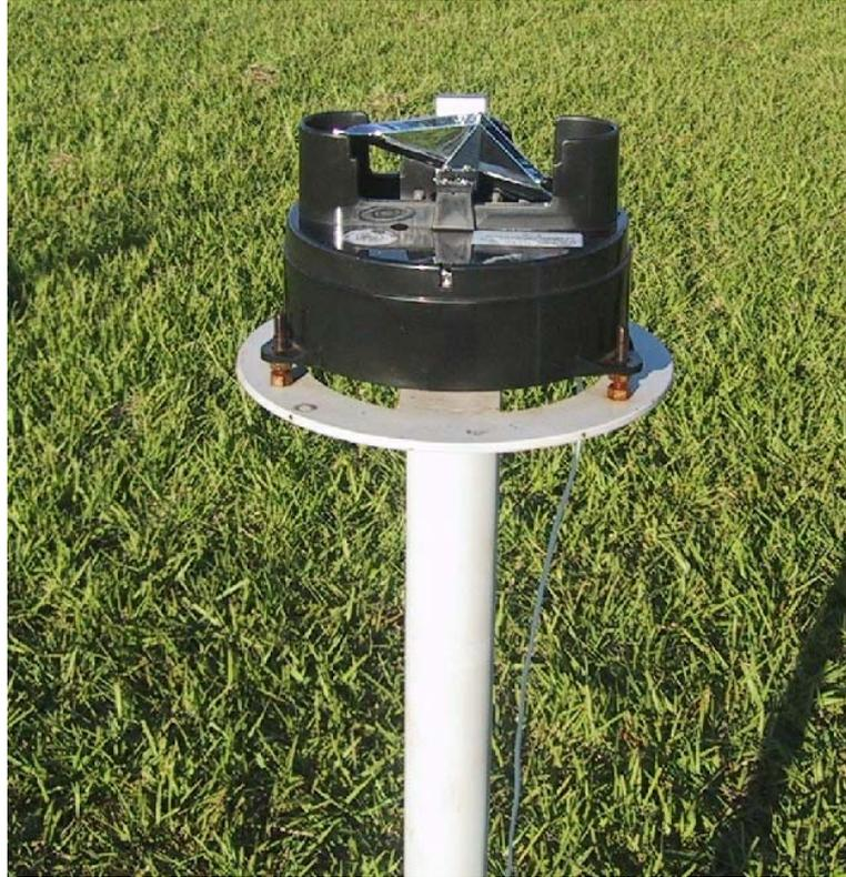
Figura 2: Pluviômetro com caçamba basculante (interior).
