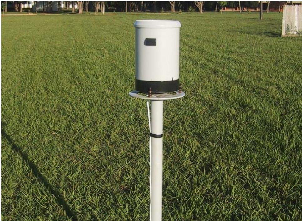
Figura 3: Pluviômetro com caçamba basculante (exterior).
