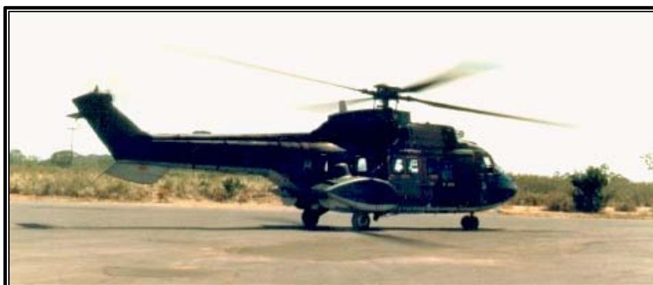
Versão mais avançada do Puma, o Super Puma é um dos mais modernos e avançados helicópteros em operação. Fabricado em cinco modelos, dois dos quais com finalidades civis, destaca-se por sua grande capacidade de transporte e resistência. Com um motor Turbomeca Makila, o Super Puma consegue desempenho superior ao Puma. Outras inovações, que o tornam mais seguro e eficiente, são as pás dos rotores em fibra de vidro e as engrenagens e rolamentos que podem funcionar sem óleo por uma hora.
