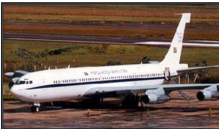
O Boeing KC-137 é uma versão militar do Boeing 707. Adaptado para reabastecimento em vôo e transporte de carga, o KC permite a FAB aumentar seu raio operacional. Em determinadas situações, o KC-137 pode ser utilizado para o transporte executivo, atendendo especialmente à Presidência da República. Voando em constante treinamento com os F-5E e A-1, os KC-137 garantem autonomia aos nossos caças para atingirem qualquer zona fronteira do território nacional.
