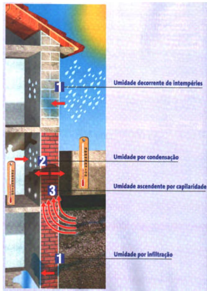
Figura 10. Tipos de umidade causadoras de patologias. FONTE: FIGUEIREDO (2003).
