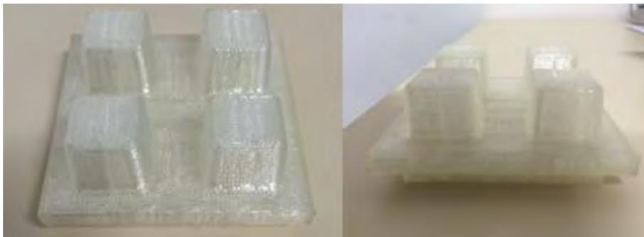
**Figura 17: Forma de laje chocolate impressa em modelo 3D.**
