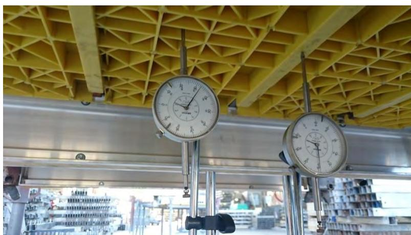
**Figura 4: Extensômetros utilizados nos testes de carga.**
