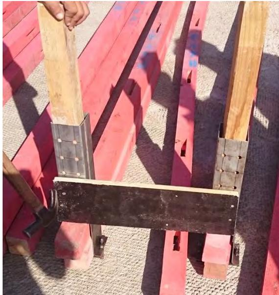
**Figura 11: LDB sendo testada com madeira na obra.**
