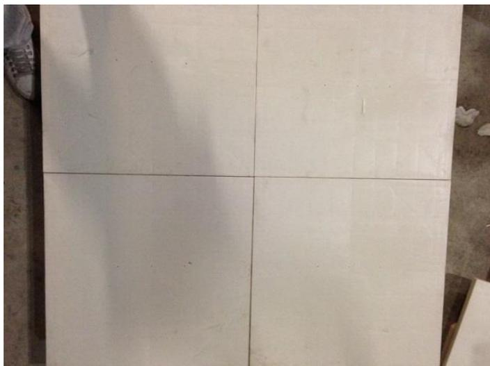
**Figura 10** *Plasterit* com 61 cm e superfície lateral lisa e arestas perpendiculares.
