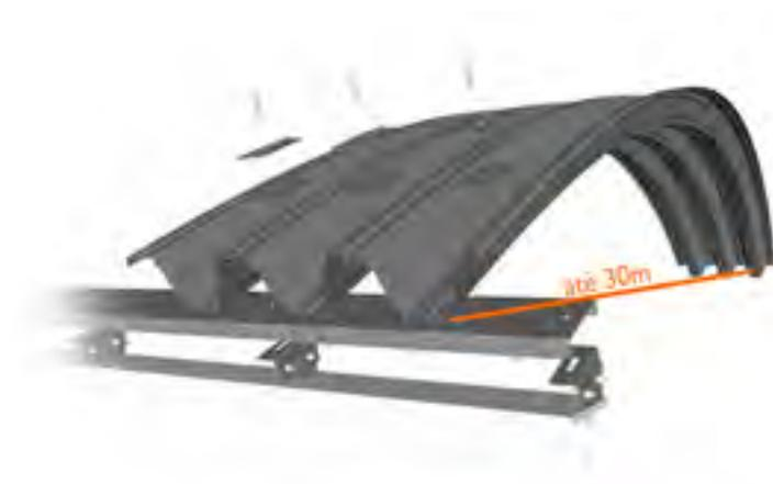
**Figura 6.** Modelo esquemático de telha autoportante
