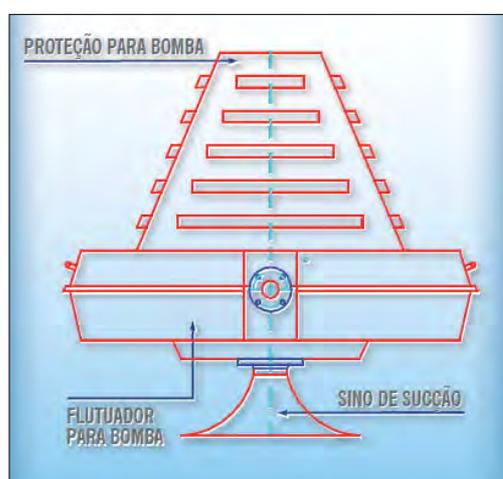
**Figura 18 – Foto e esquema do Flutuador Float Cap.[9]**
