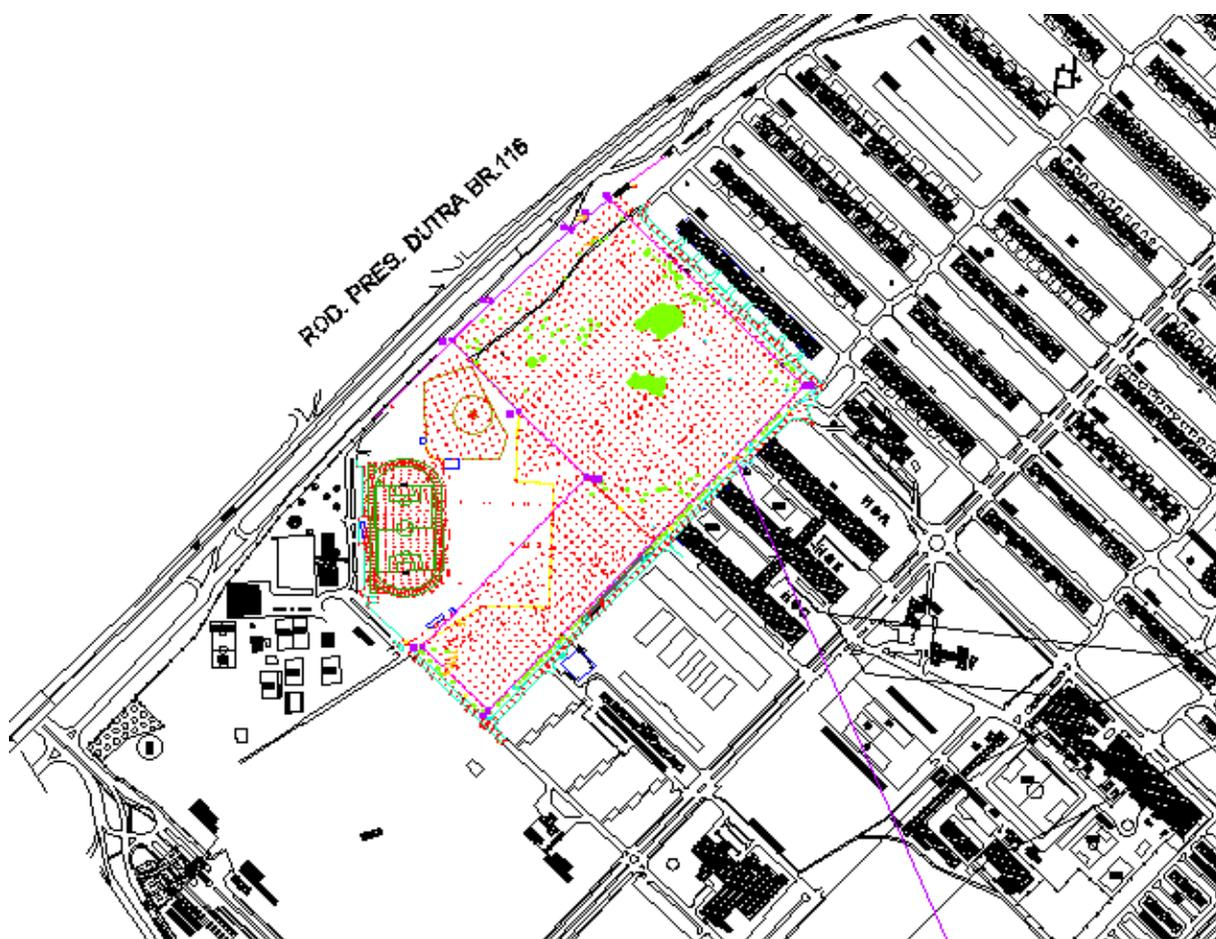
Figura 2 – Pontos levantados (em vermelho) para construção do futuro CPOR.
