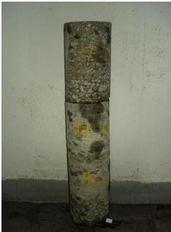
Figura 2 – Corpo de prova da pista de pouso
