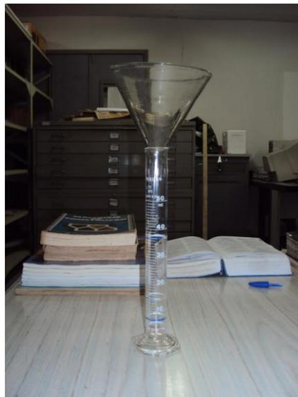
**Figura 8 – Pluviômetro com marcações indicativas do *first flush***
