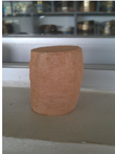
Figura 5: Aspecto do corpo-de-prova compactado (após a ruptura) utilizado em ensaio de compressão triaxial.
