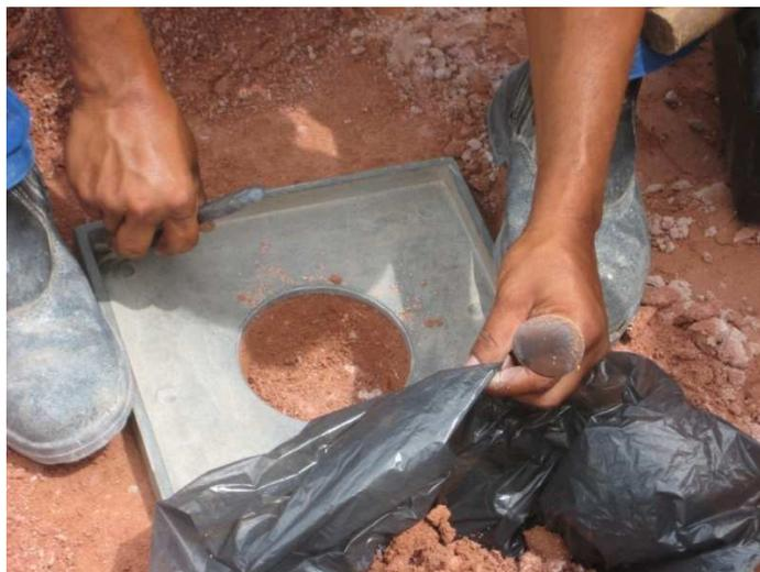
Figura 17 - Retirada de amostra para ensaio
