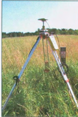
Figura 15 - Base Station posicionada.
