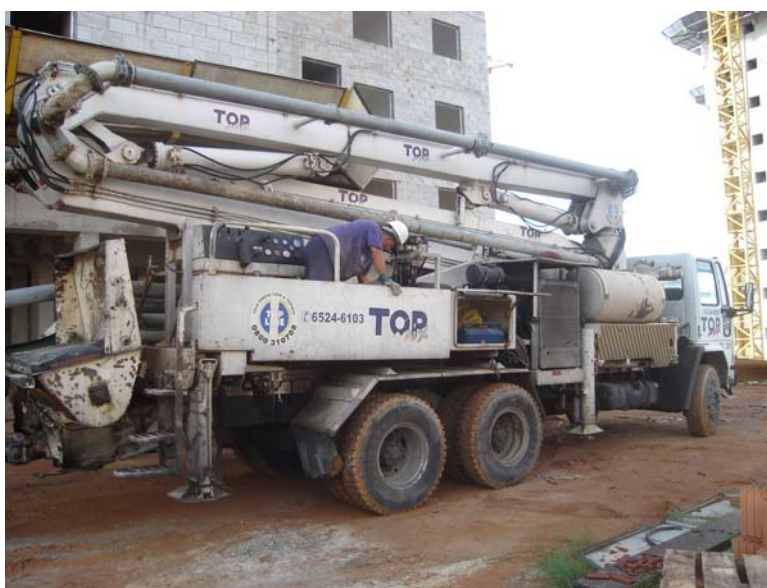
Figura 30: Carro bomba (capaz de lançar concreto até o 6º andar sem tubulação auxiliar).
