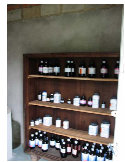
Fig. 04 - Armazenagem precária dos produtos químicos
